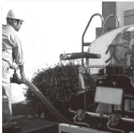
写真は給水車への給水の様子です。この給水車は1,700リットルの水を給水できます。
