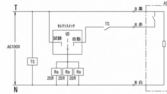
2ER：リコンプレッサー(2P30AF/20AT, 30mA, 操作電圧100V)
