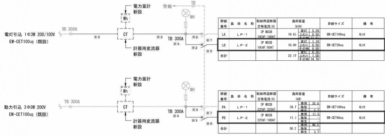
引込開閉器盤 結線図 (改修)
