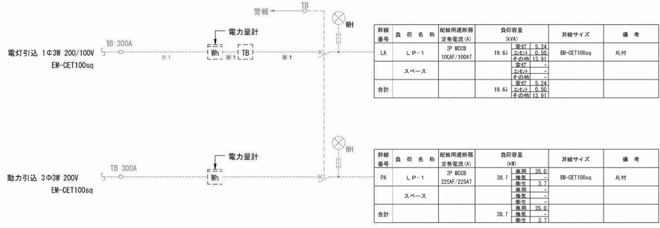
引込開閉器盤 結線図 (既設)
